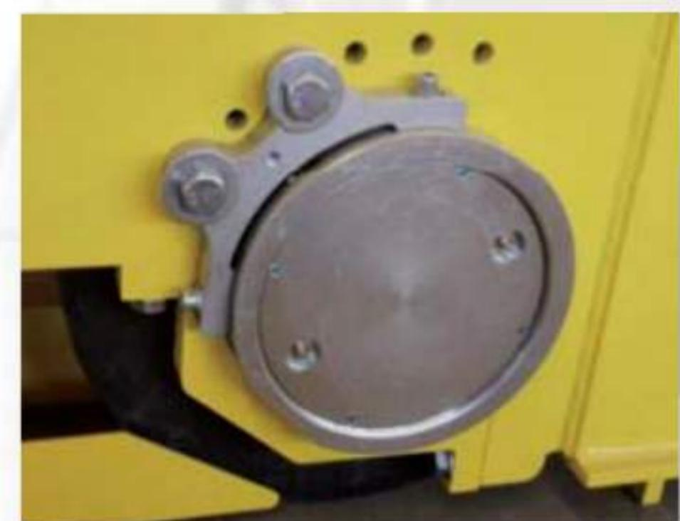
Inclinación vertical ajustable y divergencia horizontal
